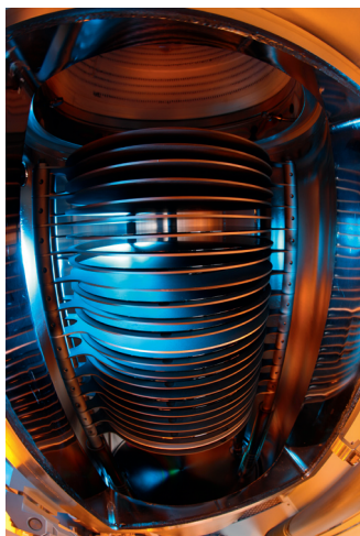
Fig. 3: Gestapelte 300-mm Elektrodenanordnung des PEDBAR-Ofens; Stacked 300 mm electrode assembly of the PEDBAR furnace.
